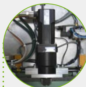
Spelfreies, genaues Positionieren der Achse durch Servomotor mit Zahnstange
